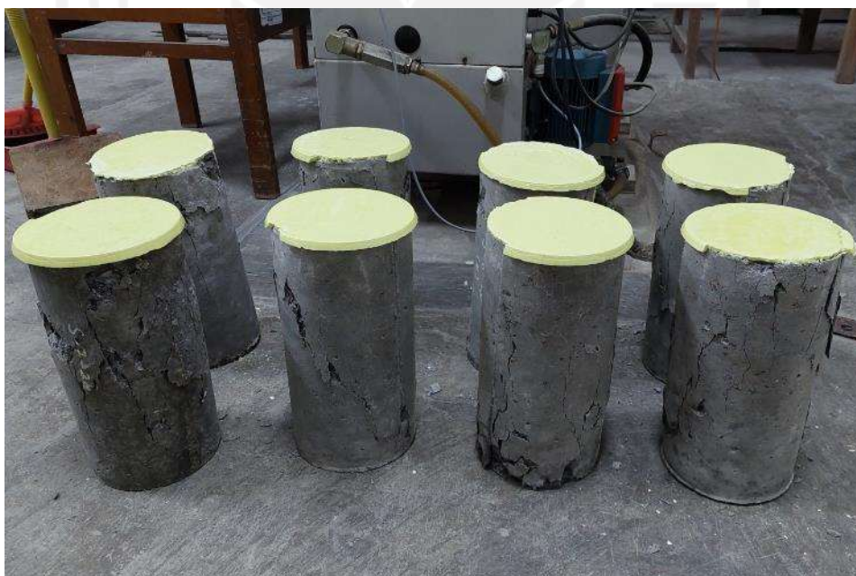
Gambar L-8.5 Benda Uji Beton Damdex Setelah Pengujian
