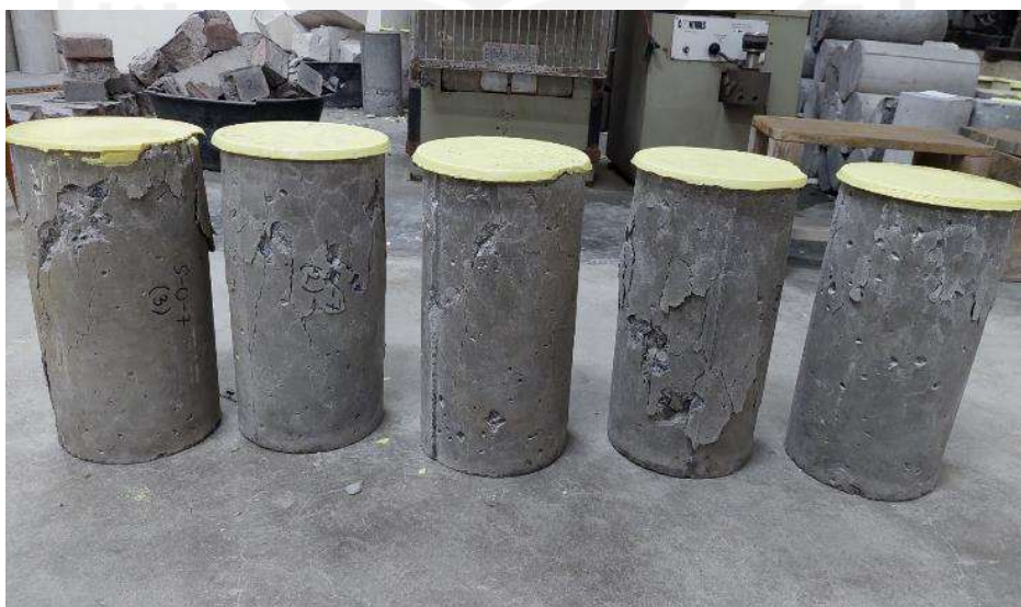
Gambar L-8.4 Benda Uji Beton Normal Setelah Pengujian
