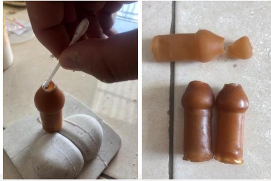
Gambar 4-19 Pengolesan Lateks Pada Kulit Dalam dan Luar (a) Kulit Dalam dan Luar Lateks Yang Digabungkan (b)
