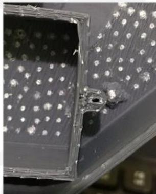
Gambar 4-11 Lubang Tidak Terbentuk Sempurna
