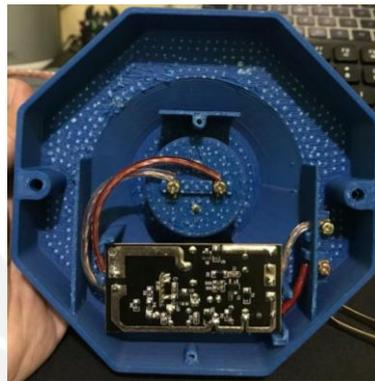
Gambar 4-26 Perakitan Smart Breaker pada Sisi Belakang
