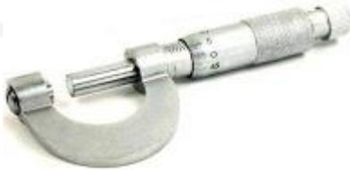
Gambar 2-12 Mikrometer Sekrup
