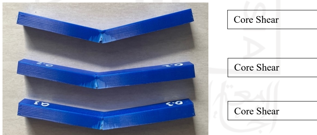
Gambar 4. 6 Spesimen tanpa lapisan komposit sandwich (tampak samping)
