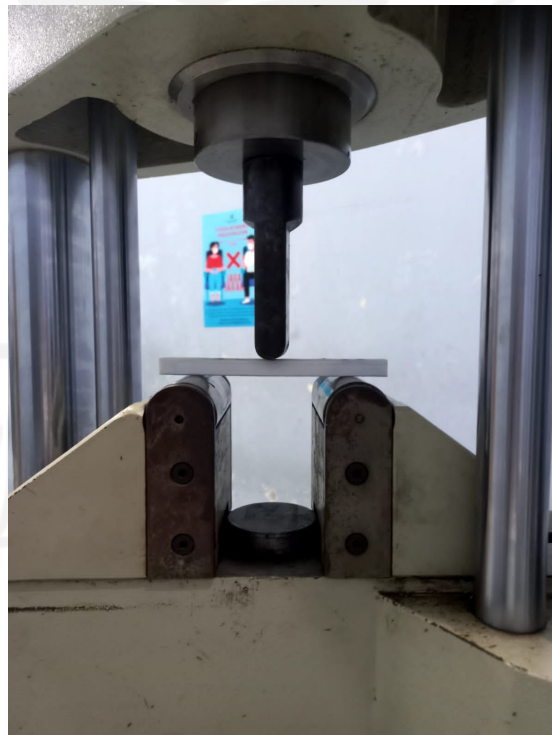
Gambar 4. 1 Proses pengujian bending spesimen
