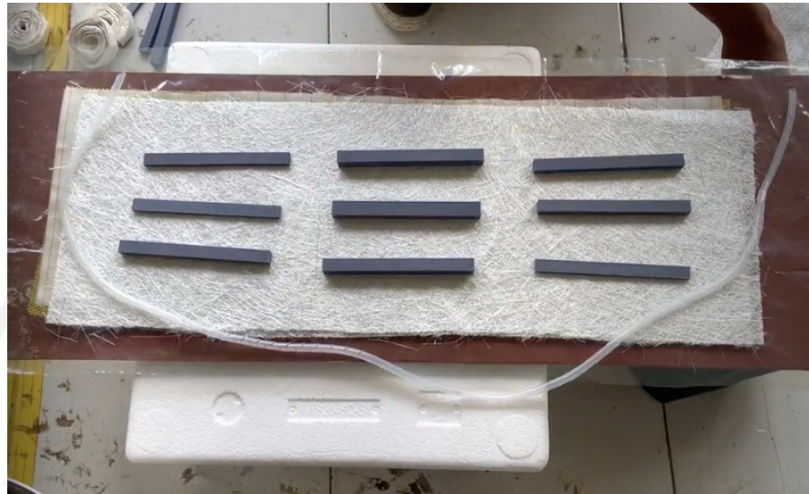
Gambar 3. 23 Pemasangan selang spiral dan spesimen
