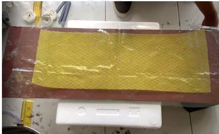
Gambar 3. 20 Pemasangan kain strimin
