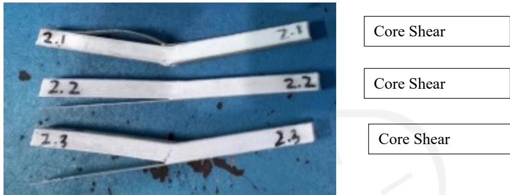
Gambar 4. 3 Spesimen komposit sandwich 2 lapis skin (tampak samping)
