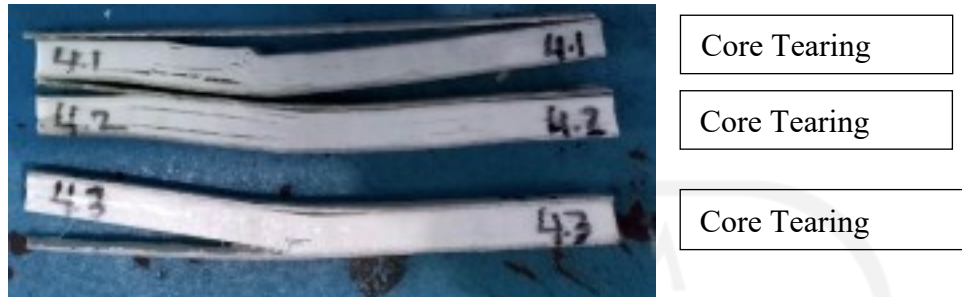
Gambar 4. 5 Spesimen komposit sandwich 4 lapis skin (tampak samping)
