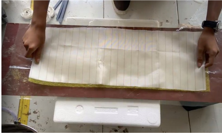
Gambar 3. 21 Pemasangan peel ply
