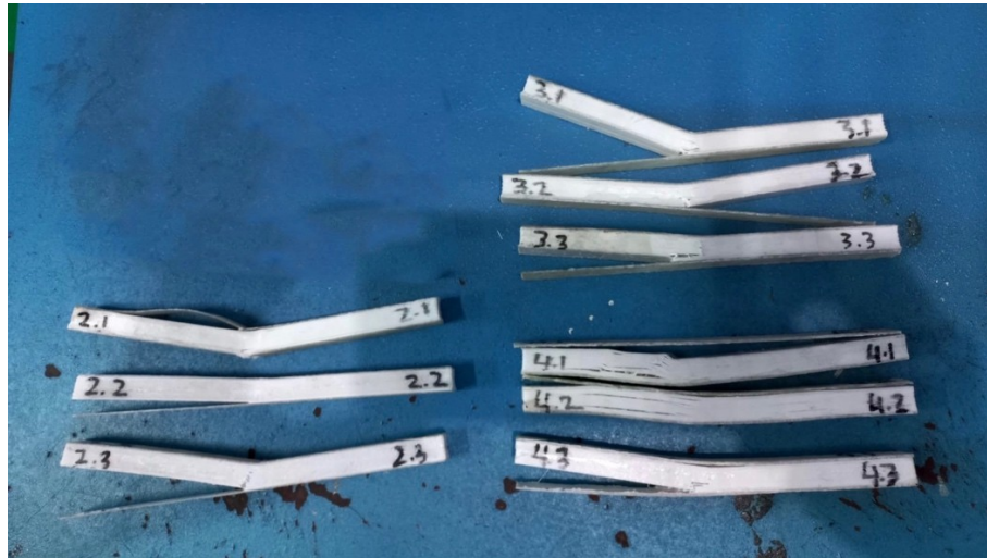
Gambar 4. 2 Spesimen komposit sandwich setelah proses pengujian
