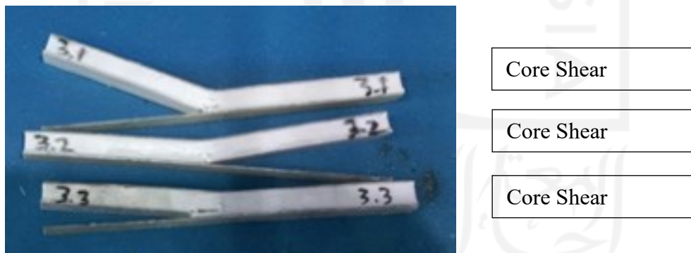
Gambar 4. 4 Spesimen komposit sandwich 3 lapis skin (tampak samping)
