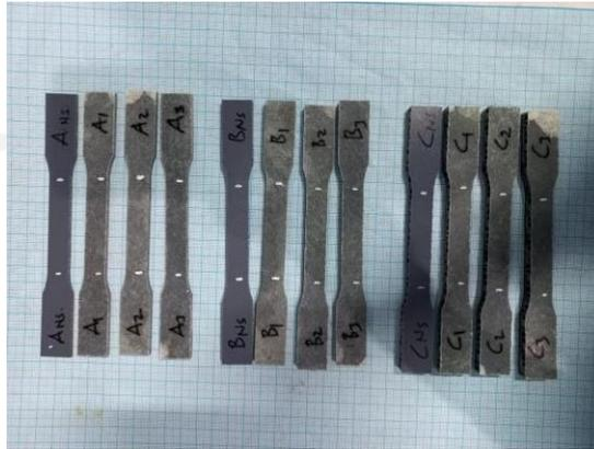
Gambar 4- 2 Spesimen sebelum di uji
