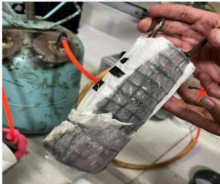
Gambar 3- 4 Hasil filter setelah terkena cairan resin
