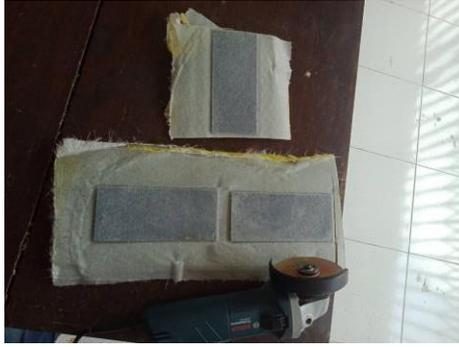
Gambar 3- 27 Proses Pemotongan dengan gerinda
