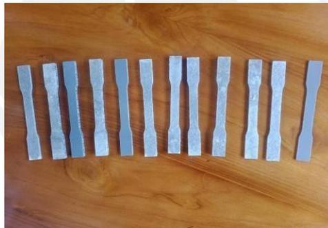
Gambar 3- 28 Spesimen hasil pemotongan dengan water jet
