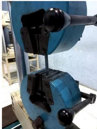
Gambar 4- 1 Proses Pengujian Tarik
