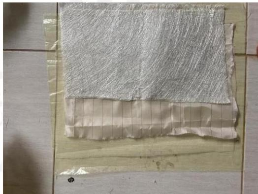
Gambar 3- 22 Susunan Komposit Sandwich
