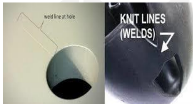
Gambar 2-15 Cacat Produksi Injection Molding
