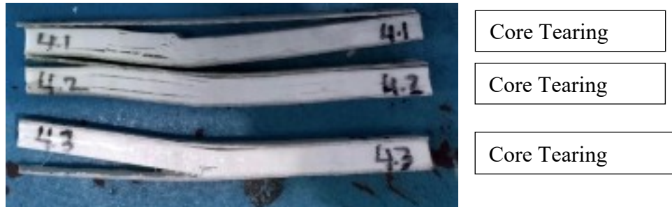
Gambar 4. 5 Spesimen komposit sandwich 4 lapis skin (tampak samping)
