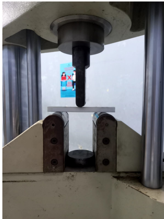
Gambar 4. 1 Proses pengujian bending spesimen
