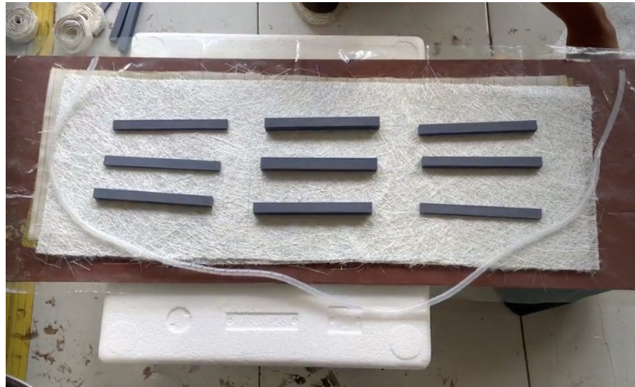
Gambar 3. 23 Pemasangan selang spiral dan spesimen
