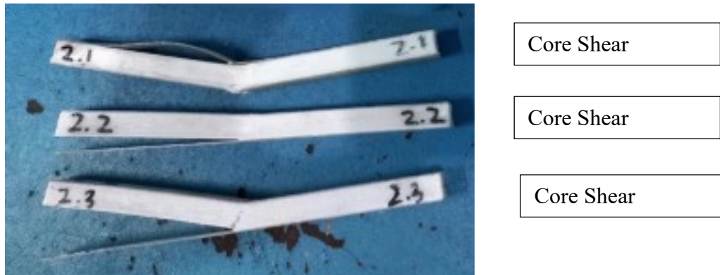
Gambar 4. 3 Spesimen komposit sandwich 2 lapis skin (tampak samping)
