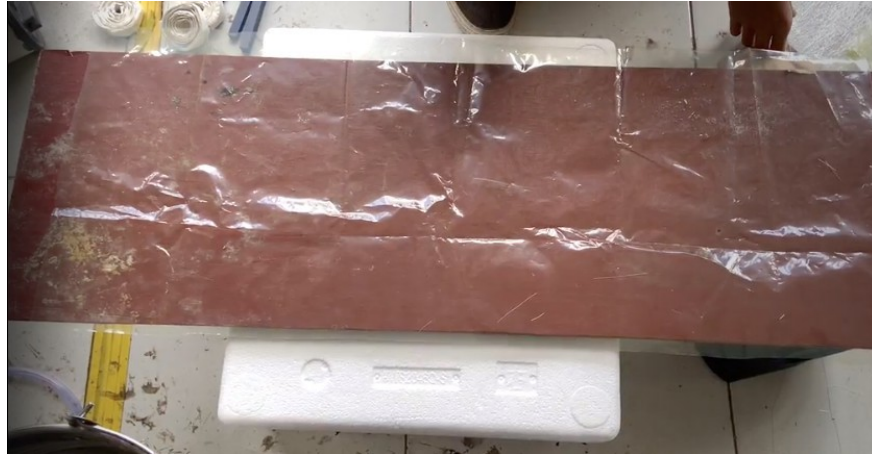
Gambar 3. 19 Pemasangan vacuum bag pada lapisan awal
