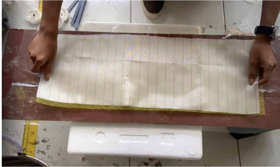
Gambar 3. 21 Pemasangan peel ply
