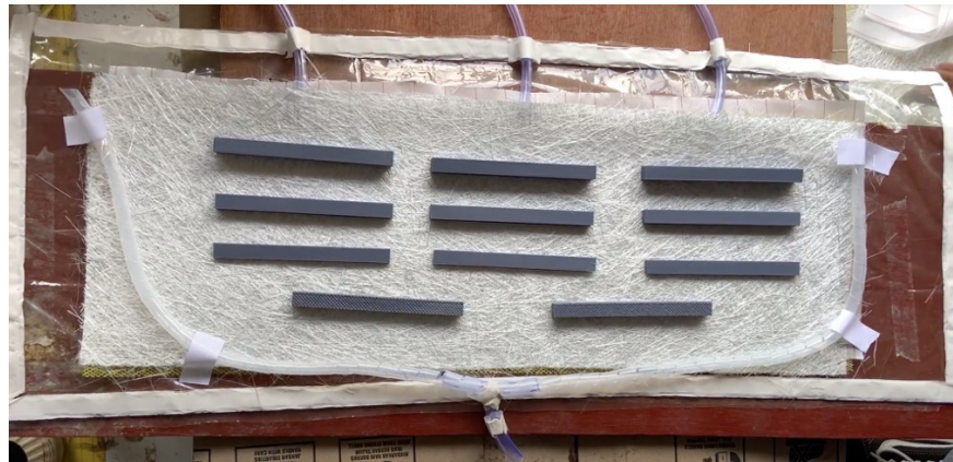
Gambar 3. 24 Pemasangan sealent tape
