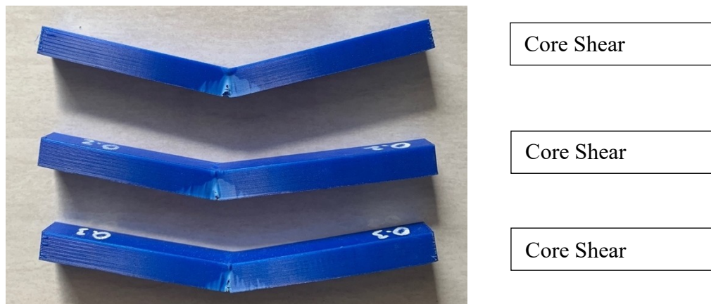
Gambar 4. 6 Spesimen tanpa lapisan komposit sandwich (tampak samping)
