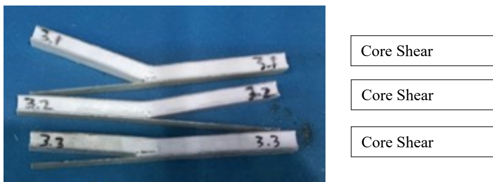
Gambar 4. 4 Spesimen komposit sandwich 3 lapis skin (tampak samping)
