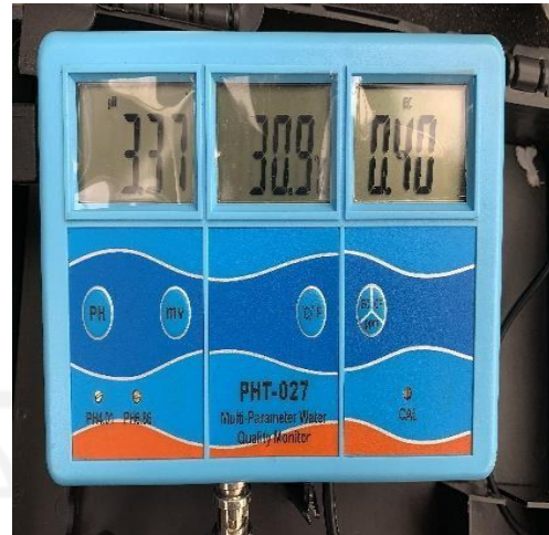
Proses pengukuran pH dan EC menggunakan ORP meter
