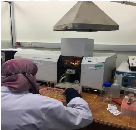
Proses uji logam berat dengan menggunakan alat SSA (Spektrofotometri Serapan Atom)
