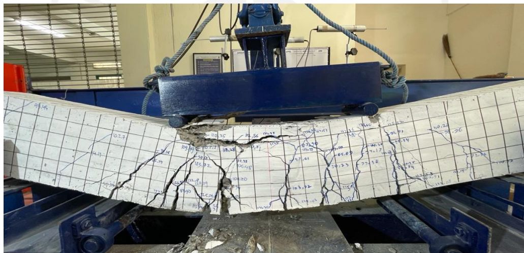
Gambar 5.11 Retak Eksperimental Balok Lentur BLA1
