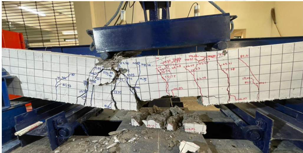
Gambar 5.19 Retak Eksperimental Balok Lentur BLA5
