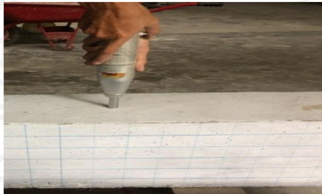
Gambar 5.1 Pengujian Hammer Test pada Benda Uji Balok
