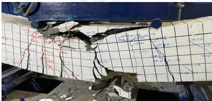
Gambar 5.9 Retak Eksperimental Balok Lentur BLK
