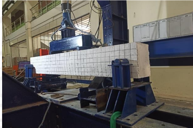
Gambar 5.5 Model Pembebanan Benda Uji Eksperimental
