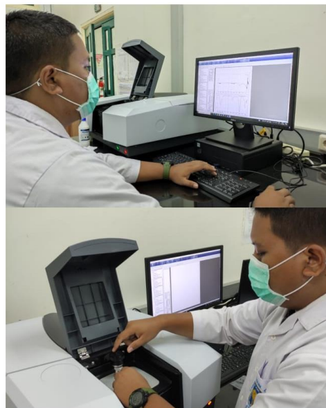
Gambar 3. 13 Proses Analisis Sampel Menggunakan FTIR
