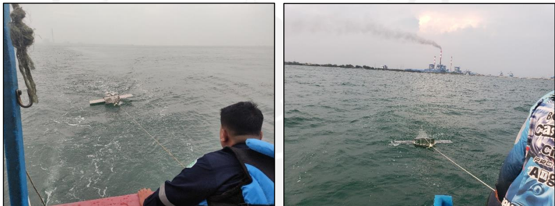
Gambar 3.10 Pengambilan Sampel Permukaan Air Laut Menggunakan Manta Trawl
