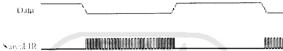
Gambar 3.8. Modulasi Sinyal Infra Merah
