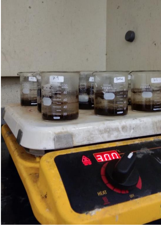
Destruksi sampel tanah di dalam lemari asam
