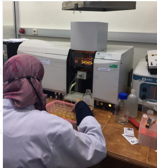
Pengujian sampel dengan AAS
