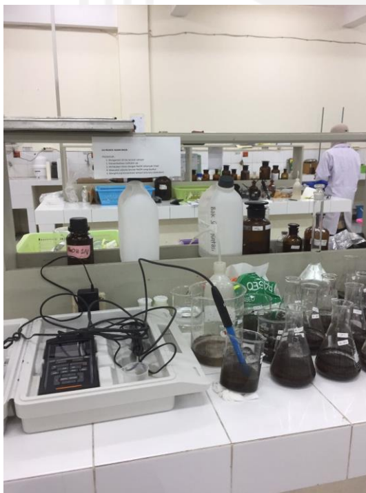
Pengujian pH tanah menggunakan pH meter
