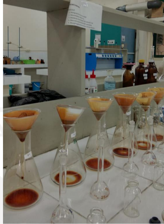
Penyaringan ekstrak hasil destruksi dengan kertas saring Whatman
