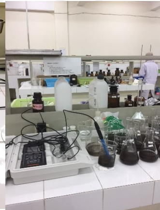
Proses pengukuran pH tanah menggunakan pH meter
