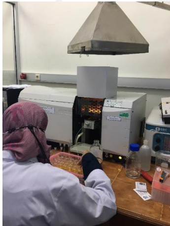
Proses uji logam berat dengan menggunakan alat SSA (Spektrofotometri Serapan Atom)
