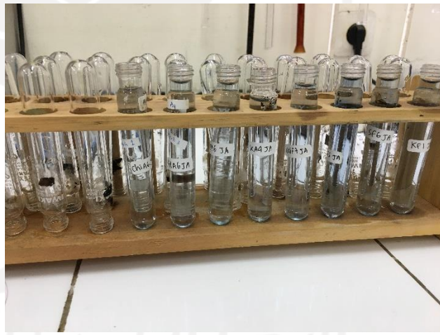
Proses uji kadar fosfat tersedia tanah dan fosfat total jaringan batang menggunakan Spektro UV-Vis
