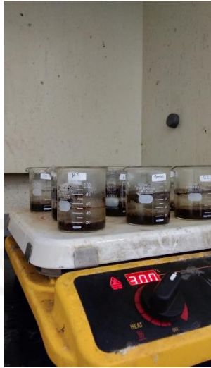
Proses destruksi sampel tanah dan jaringan tanaman dengan hotplate
