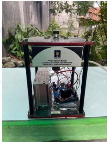
Gambar 3-4 Perangkat keras *motor servo base unit*.
