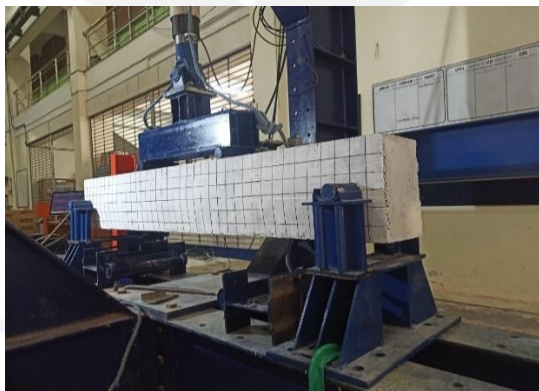
Gambar 5. 5 Pemodelan Pembebanan Benda Uji Eksperimental
