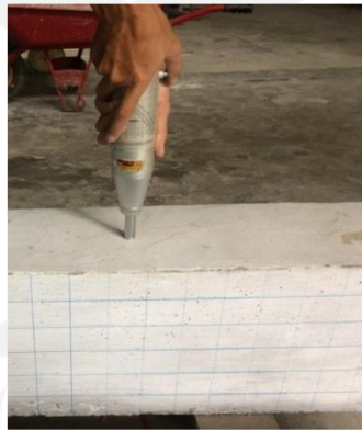
Gambar 5. 1 Pengujian Hammer Test pada Balok Benda Uji
