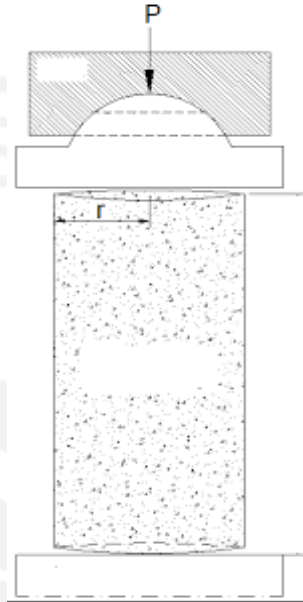
Gambar 3. 6 Sketsa Pengujian Kuat Tekan Silinder
