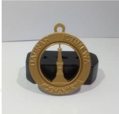
Gambar 4-32 Finishing tugu Yogyakarta menggunakan coating pylox
