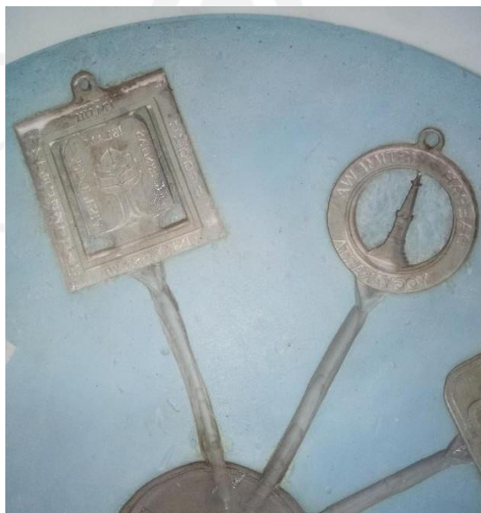
Gambar 4-36 Runner tidak lurus dan gate tidak simetris
