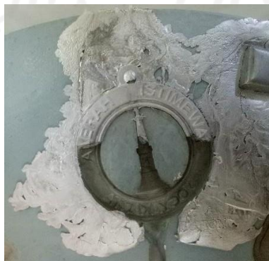
Gambar 4-34 Produk tidak terisi dengan sempurna
