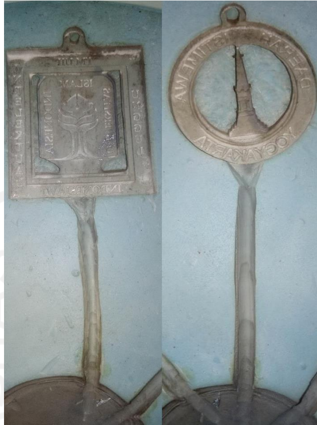
Gambar 4-37 Runner tidak lurus dan gate tidak simetris
