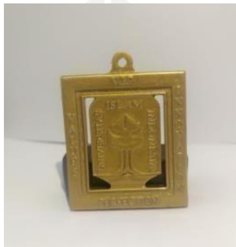
Gambar 4-33 Finishing logo UII menggunakan coating pylox
