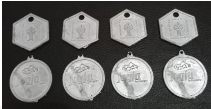
Gambar 4- 1 hasil pengecoran dengan kecepatan 450 rpm (CW)
