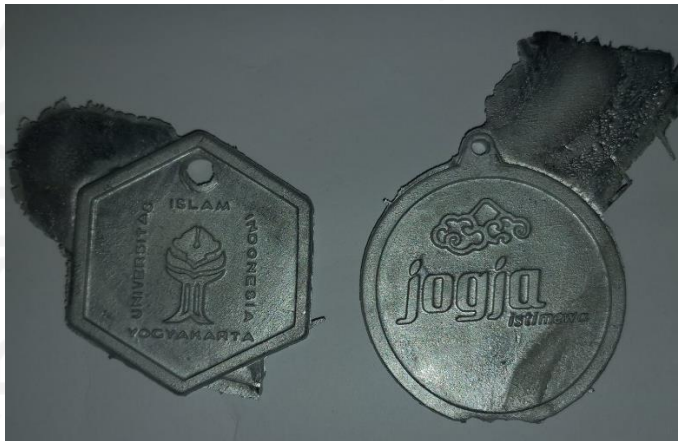
Gambar 4- 29 gambar hasil pengecoran 30 psi
