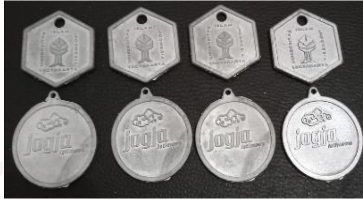
Gambar 4- 12 hasil pengecoran dengan kecepatan 750 rpm (CCW)
