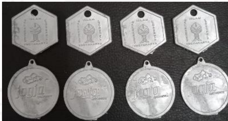
Gambar 4- 2 hasil pengecoran dengan kecepatan 550 rpm (CW)
