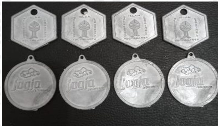
Gambar 4- 10 hasil pengecoran dengan kecepatan 550 rpm (CCW)
