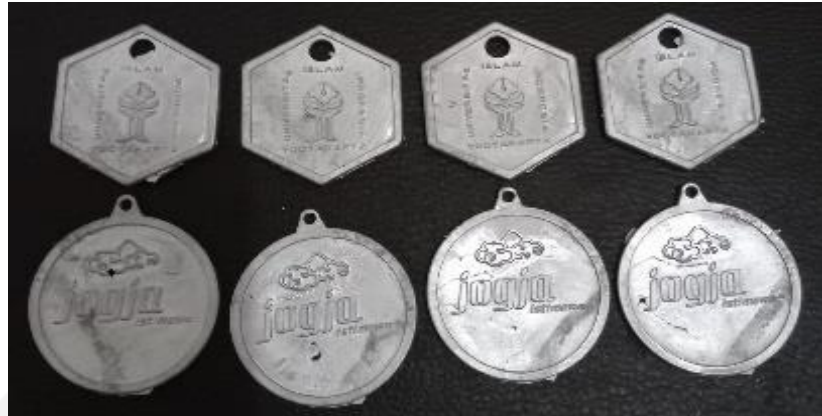
Gambar 4- 9 hasil pengecoran dengan kecepatan 450 rpm (CCW)
