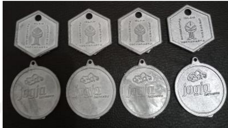
Gambar 4- 4 hasil pengecoran dengan kecepatan 750 rpm (CW)
