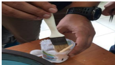
Gambar 3- 20 Melapisi lapisan resin pada permukaan master
