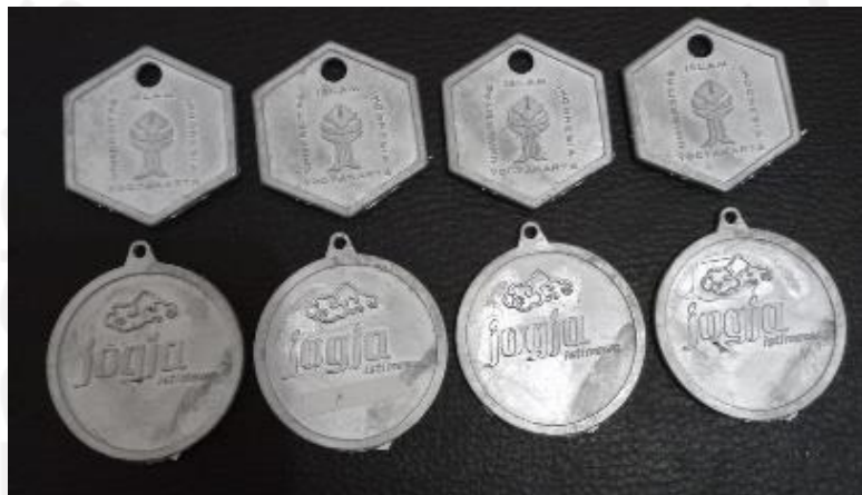
Gambar 4- 10 hasil pengecoran dengan kecepatan 550 rpm (CCW)
