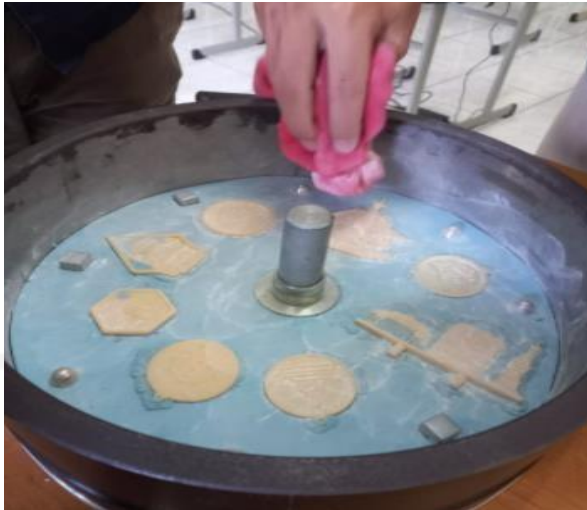
Gambar 3- 22 Peletakan master dan pemberian tepung pada silicone rubber
