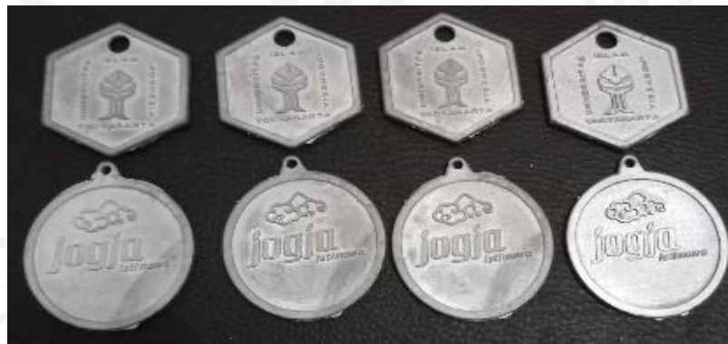
Gambar 4- 19 hasil pengecoran dengan tekanan 35 psi
