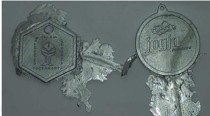
Gambar 4- 28 gambar hasil pengecoran tekanan 25 psi
