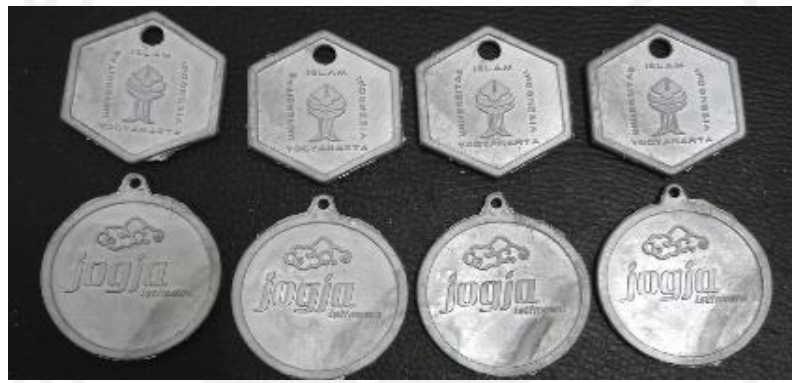
Gambar 4- 19 hasil pengecoran dengan tekanan 35 psi
