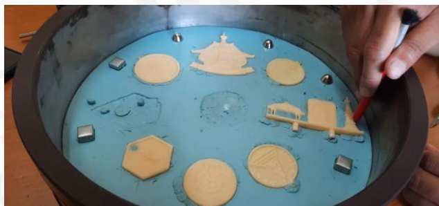
Gambar 3- 21 Pembuatan coakan pada silicone rubber
