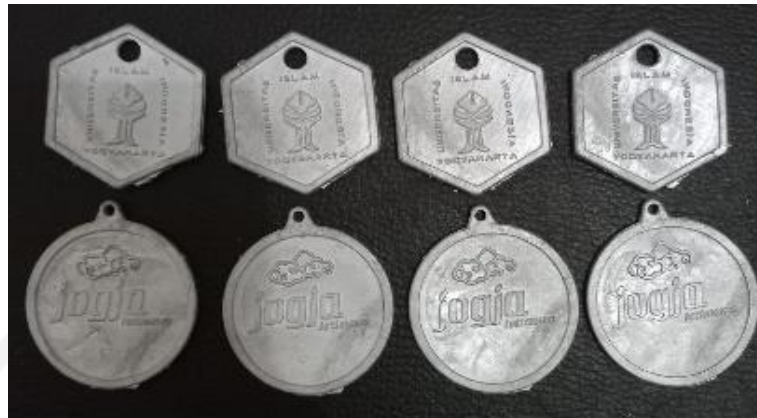
Gambar 4- 21 hasil pengecoran dengan tekanan 45 psi
