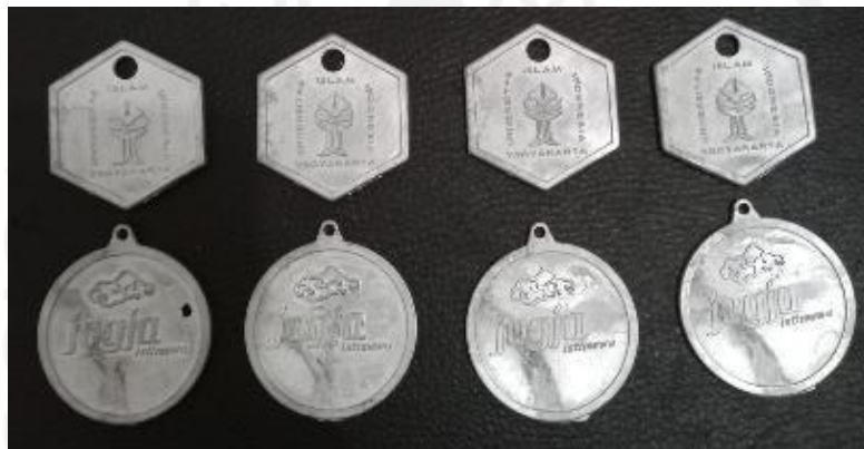
Gambar 4- 2 hasil pengecoran dengan kecepatan 550 rpm (CW)
