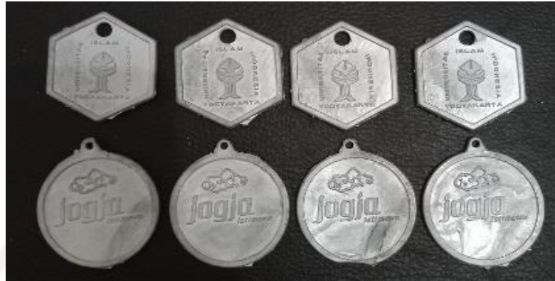
Gambar 4- 18 hasil pengecoran dengan tekanan 30 psi
