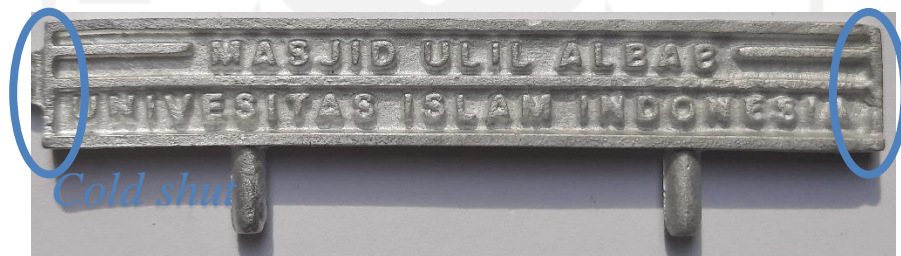
Gambar 4-51 Identifikasi kecacatan hasil pengecoran variasi tekanan
