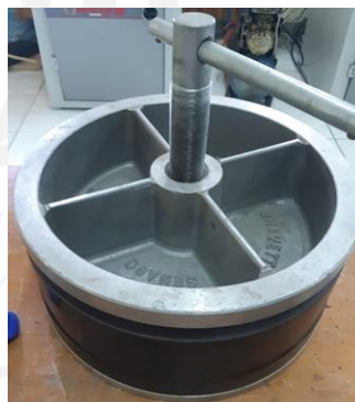
Gambar 3-19 Penutupan cetakan rubber
