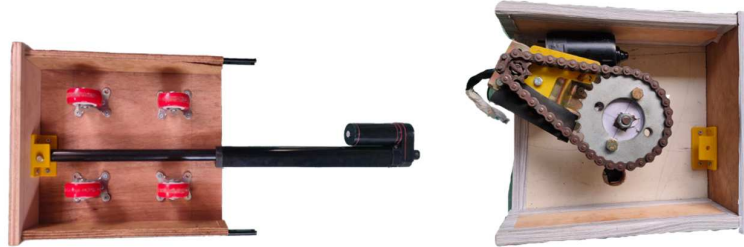
Gambar 4-9 Penambahan Linear Actuator dan Motor Wiper
