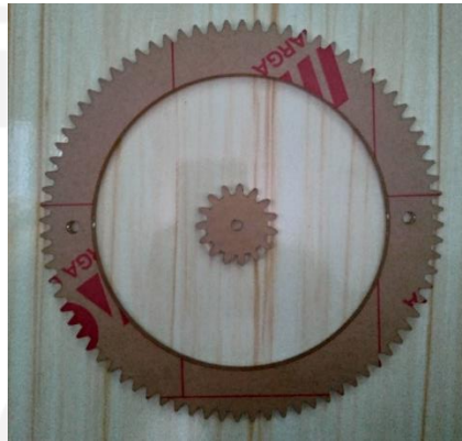
Gambar 4-27 Komponen roda gigi setelah proses laser cutting
