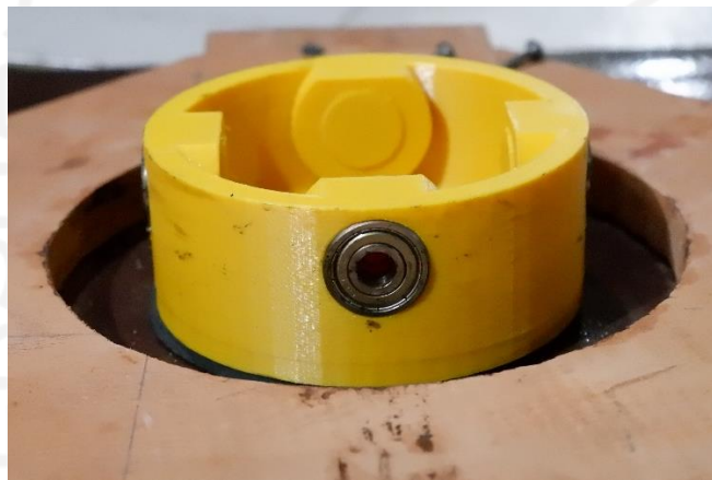
Gambar 4-35 Pemasangan bearing 6088 zz pada penopang batang stainless steel
