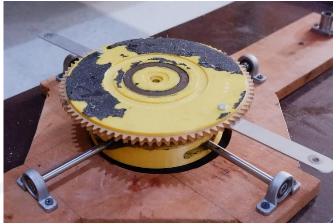
Gambar 4-37 Pemasangan batang stainless steel pada cylindrical cam
