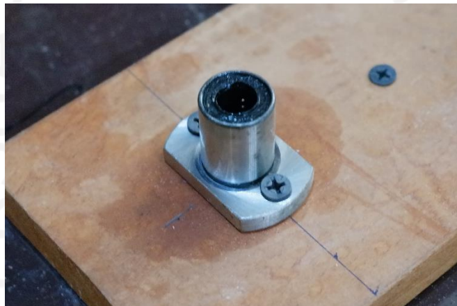
Gambar 4-38 Pemasangan linear bearing LMH 10 LUU pada rangka tengah
