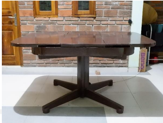
Gambar 4-45 Hasil perakitan meja makan extendable kondisi diperpanjang
