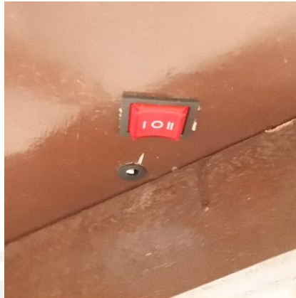
Gambar 4-42 Pemasangan saklar DPDT dan lubang adaptor 12 V
