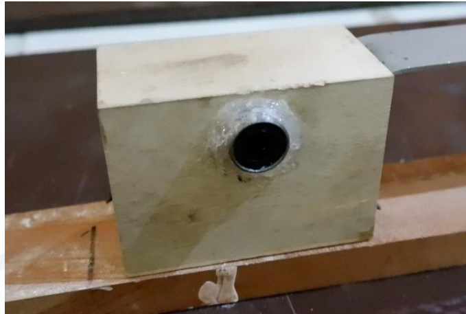
Gambar 4-32 Komponen linear bearing pada panel tepi meja
