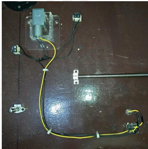
Gambar 4-41 Rangkaian komponen kelistrikan pada purwarupa
