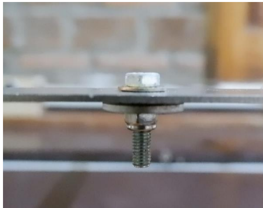
Gambar 4-33 Pemasangan lock nut M5 pada sambungan batang penghubung
