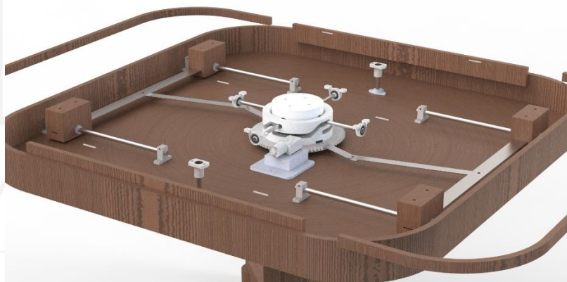
Gambar 4-19 Komponen mekanik pada meja makan extendable
