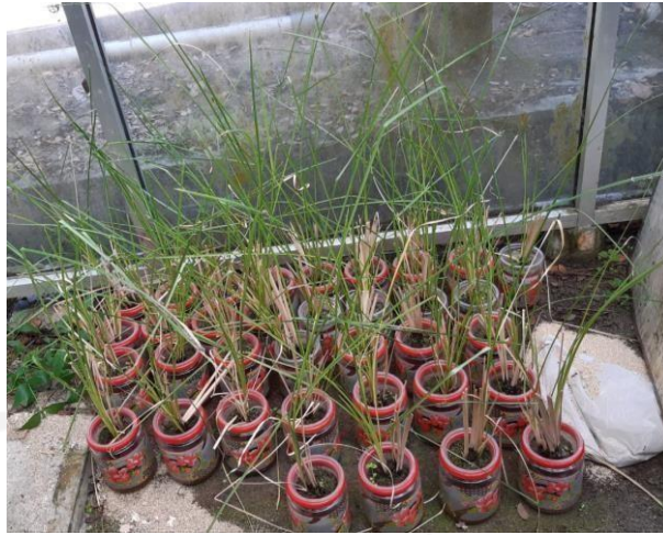
Gambar 3.12 Reaktor FTW dan Tanaman Vetiveria zizanioides Setelah Aklimatisasi
