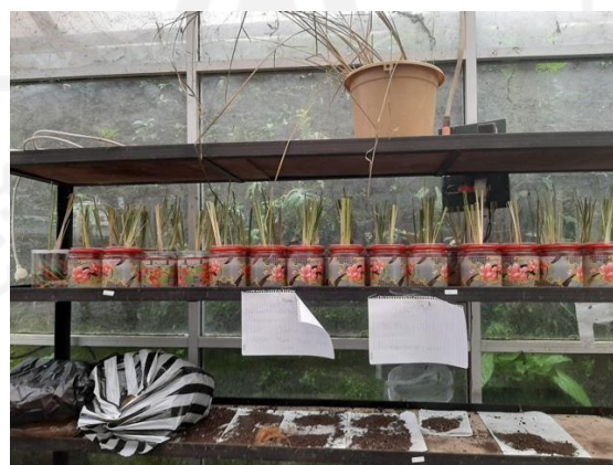
Gambar 3.11 Reaktor FTW dan Tanaman Vetiveria zizanioides
