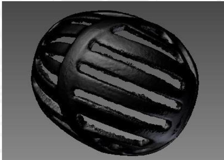
Gambar 4.20 Hasil *Scan* Helm Setelah Proses Komposit *Sandwich Vacuum Infusion*
