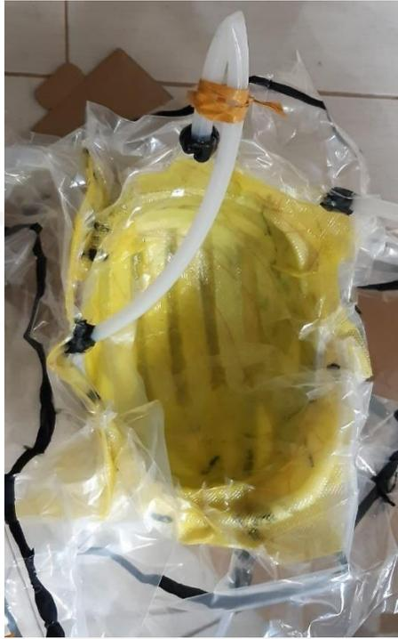
Gambar 4.11 Proses *Vacuum Infusion* Helm Sepeda Desain Kedua
