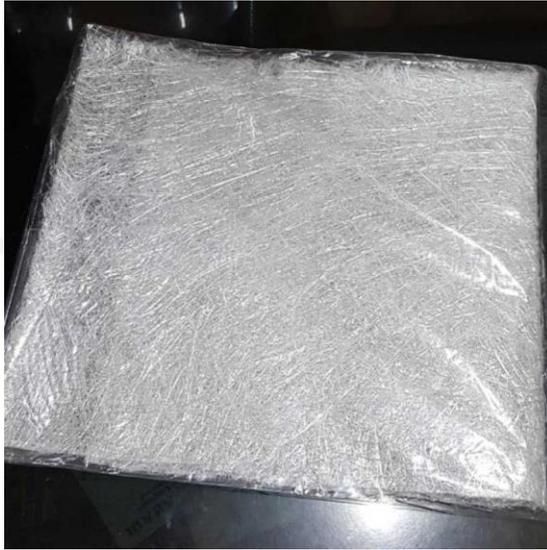
Gambar 3.13 Serat Kaca atau *Fiberglass*
