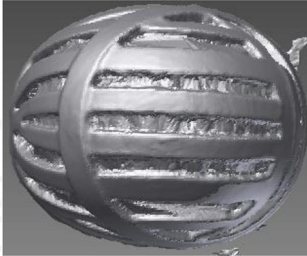
Gambar 4.21 Helm Sepeda Setelah Proses Cetak 3D *Print File STEP*
