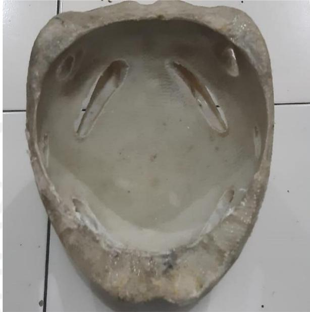
Gambar 4.10 Hasil Proses *Vacuum Infusion* Bagian Dalam Helm Sepeda
