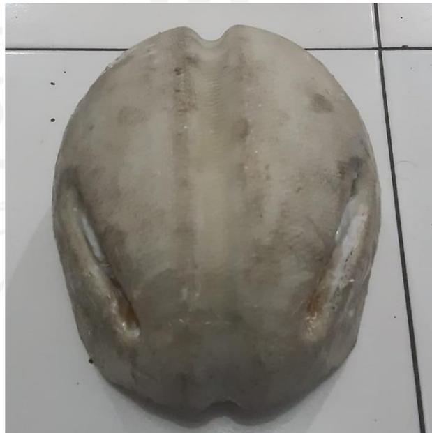
Gambar 4.8 Hasil Proses *Vacuum Infusion* Bagian Luar Helm Sepeda
