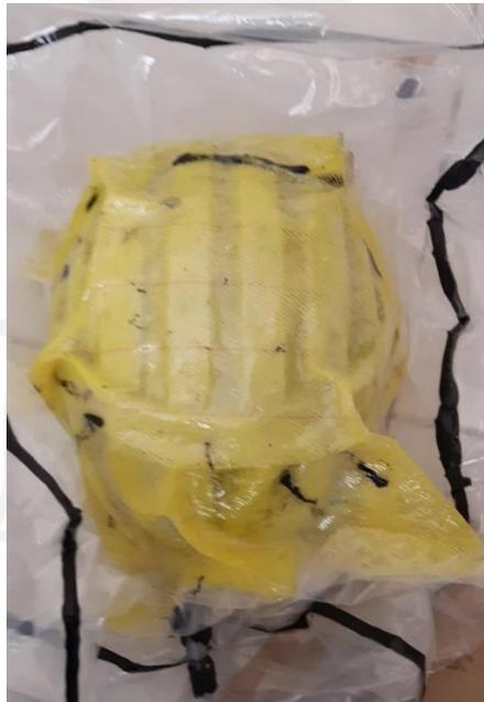
Gambar 4.12 Proses *Vacuum Infusion* Helm Sepeda Desain Kedua
