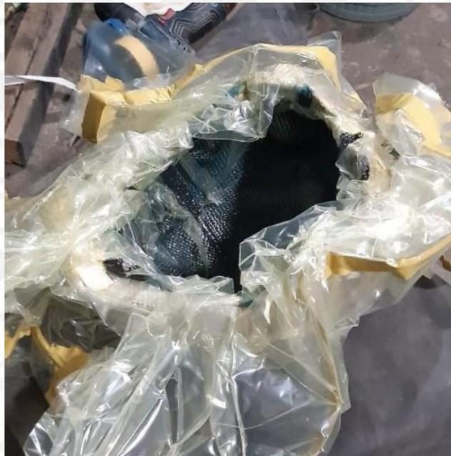
Gambar 4.9 Proses *Vacuum Infusion* Bagian Dalam Helm Sepeda
