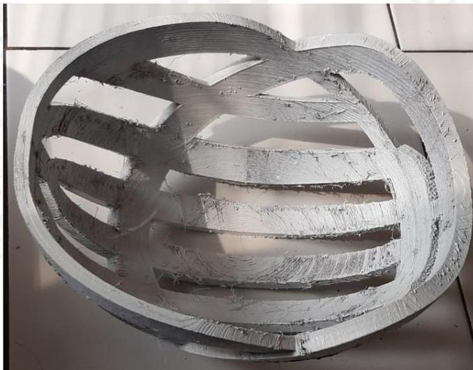
Gambar 4.14 Hasil Proses *Vacuum Infusion* Helm Sepeda Desain Kedua
