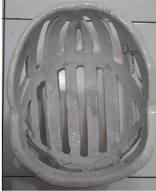
Gambar 4.18 Hasil *Finishing* Helm Sepeda Desain Kedua
