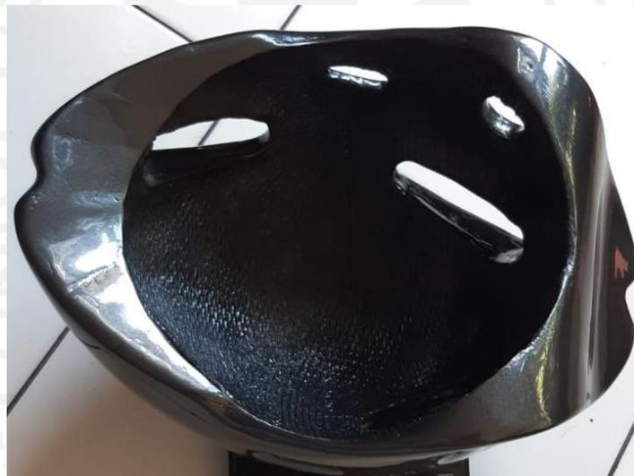
Gambar 4.15 Hasil *Finishing* Helm Sepeda Desain Pertama
