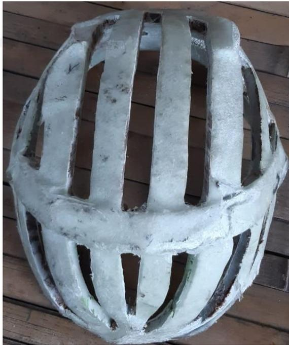
Gambar 4.13 Hasil Proses *Vacuum Infusion* Helm Sepeda Desain Kedua
