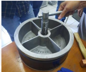
Gambar 3-10 Memasang penutup mold frame
