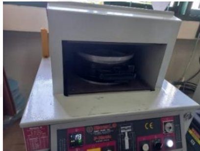
Gambar 3-11 Memasukkan mold frame ke dalam mesin vulkanisir
