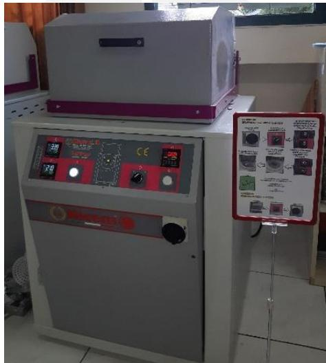
Gambar 3.4 Mesin pelebur logam *F-120 Matic*
