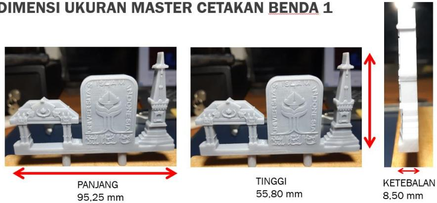
Gambar 4.3 Dimensi ukuran master cetakan benda satu
