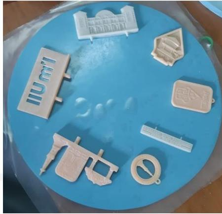
Gambar 3.13 Penataan master pada *silicone rubber*
