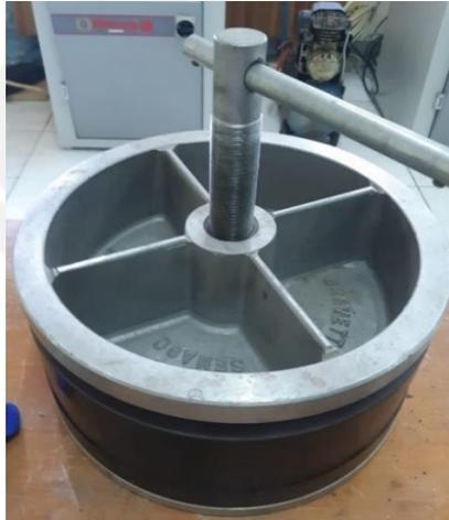
Gambar 3.17 Menutup serta mengunci *moulding frame*
