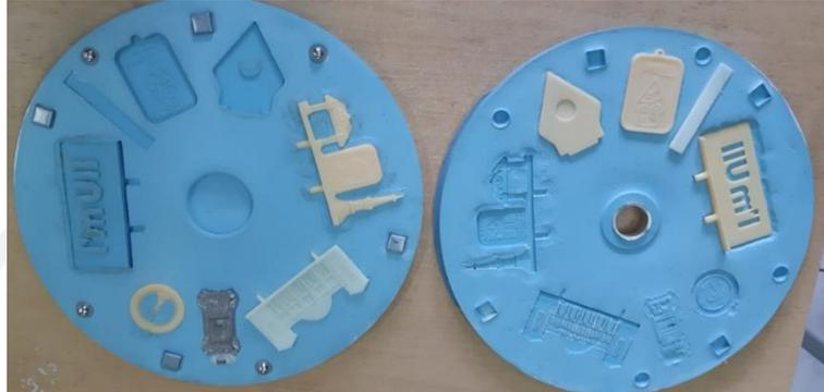
Gambar 4.5 Hasil vulkanisir silicone rubber secara keseluruhan
