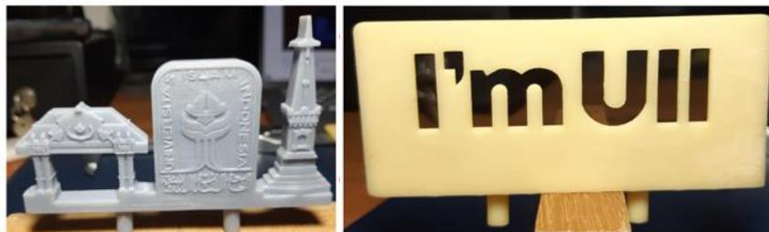
Gambar 3.12 Master untuk vulkanisir cetakan
