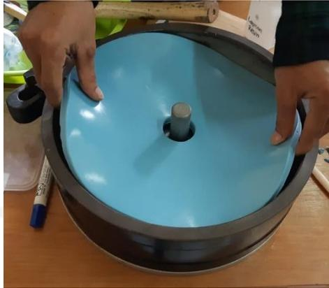
Gambar 3.16 Peletakan rubber bagian atas
