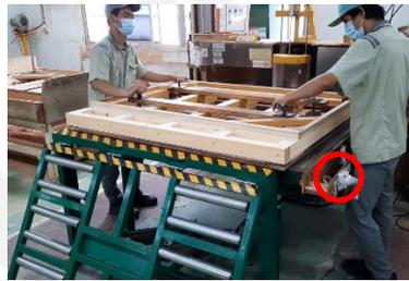
Gambar 4. 14 Penerapan Prinsip K3 pada Mesin *Lifter*
