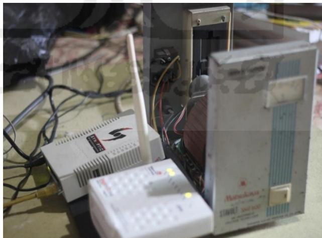
**Gambar 4. 21** Percobaan *accesspoint* dan *routerboard* diberi hambatan dengan stabilizer
