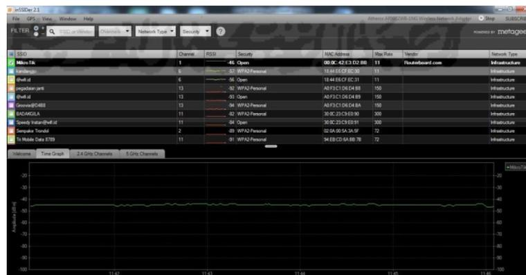
**Gambar 4.17** Sinyal *wifi* tanpa kabel pada jarak 5 meter
