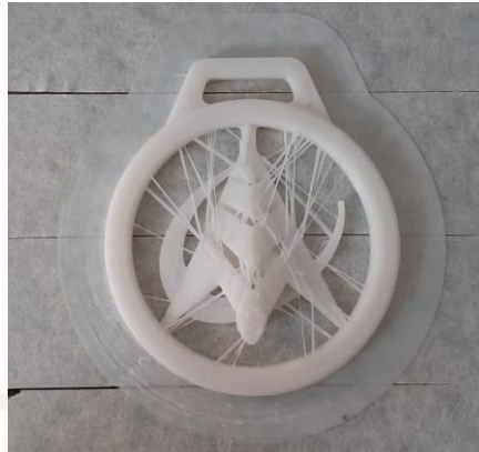
Gambar 3-14 Hasil Pemesinan 3D Printing
