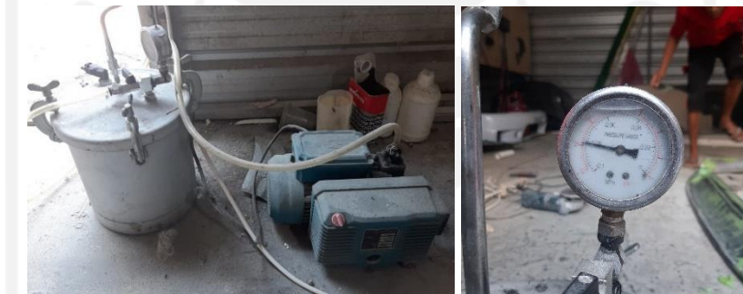
Gambar 4-10 Proses Vakum Pembuatan Cetakan Silikon Percobaan Kedua
