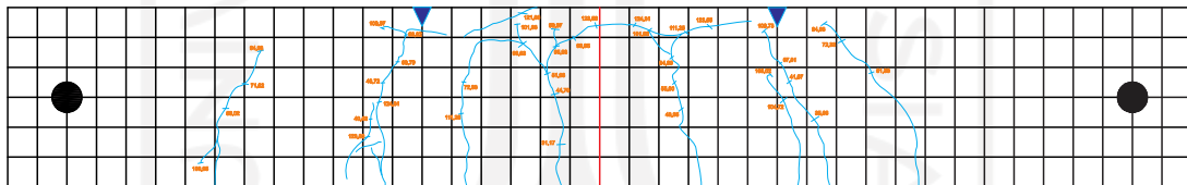
Gambar 5.20 Tampak Depan Pola Retakan Benda Uji BL1
