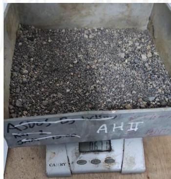
**Gambar 5.13 Pengujian Kandungan Lumpur pada Agregat Halus**
