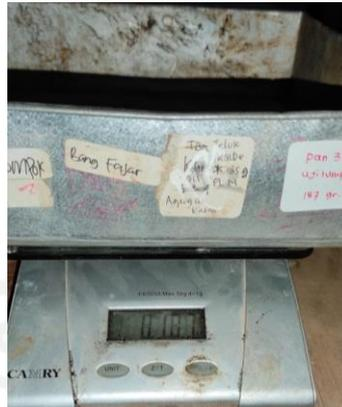
**Gambar 5.14 Berat Pan Pengujian Kandungan Lumpur pada Agregat Halus**
