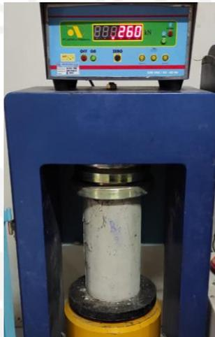
**Gambar 5.22 Pengujian Kuat Tekan Beton BS9 (2)**
