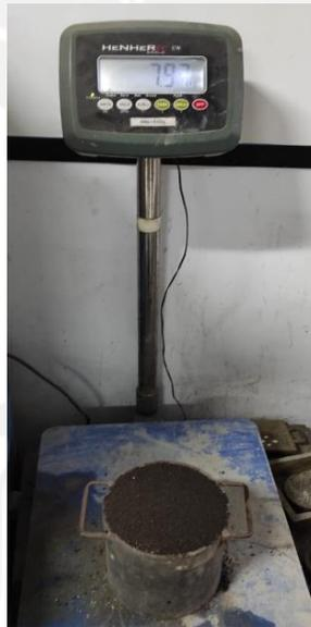
**Gambar 5.8 Pengujian Berat Isi Padat Agregat Halus**
