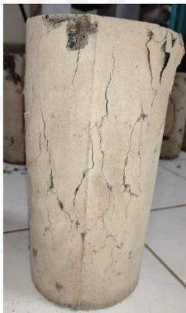
**Gambar 5.23 Beton BS9 (2) Setelah Uji Tekan**
