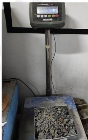
**Gambar 5.1 Pengujian Berat Jenis dan Penyerapan Agregat Kasar**
