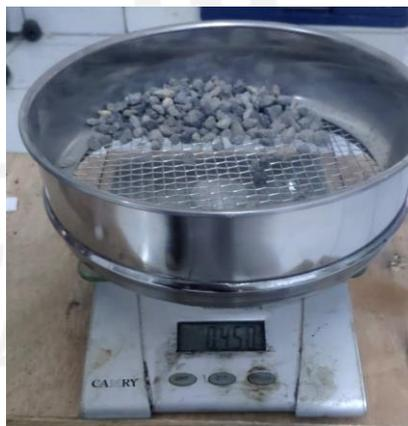
**Gambar 5.10 Agregat Halus yang Tertahan di Saringan No. 4**
