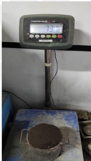
**Gambar 5.9 Pengujian Berat Isi Gembur Agregat Halus**
