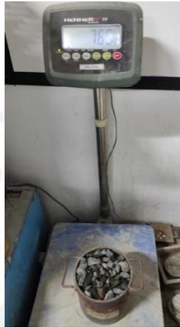
**Gambar 5.3 Pengujian Berat Isi Gembur Agregat Kasar**
