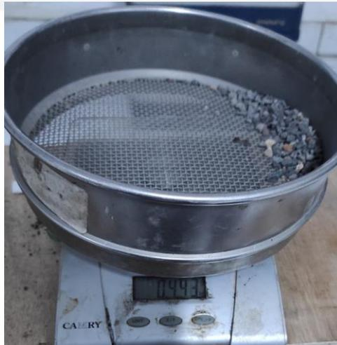
**Gambar 5.4 Agregat Kasar yang Tertahan di Saringan No. 8**
