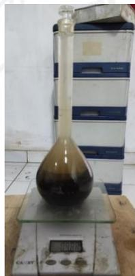
**Gambar 5.7 Pengujian Berat Jenis dan Penyerapan Air Agregat Halus**
