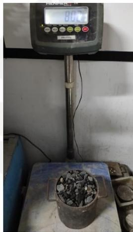
**Gambar 5.2 Pengujian Berat Isi Padat Agregat Kasar**
