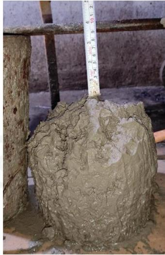
**Gambar 5.20 Pengujian Slump**
