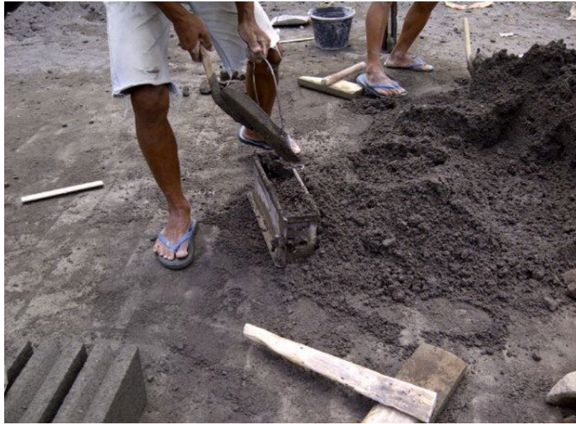
Gambar 3.1 Pembuatan Batako dengan Tangan
