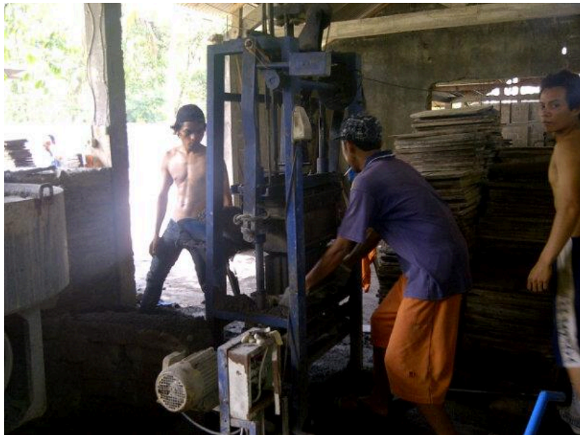
Gambar 3.2 Pembuatan Batako dengan Mesin
