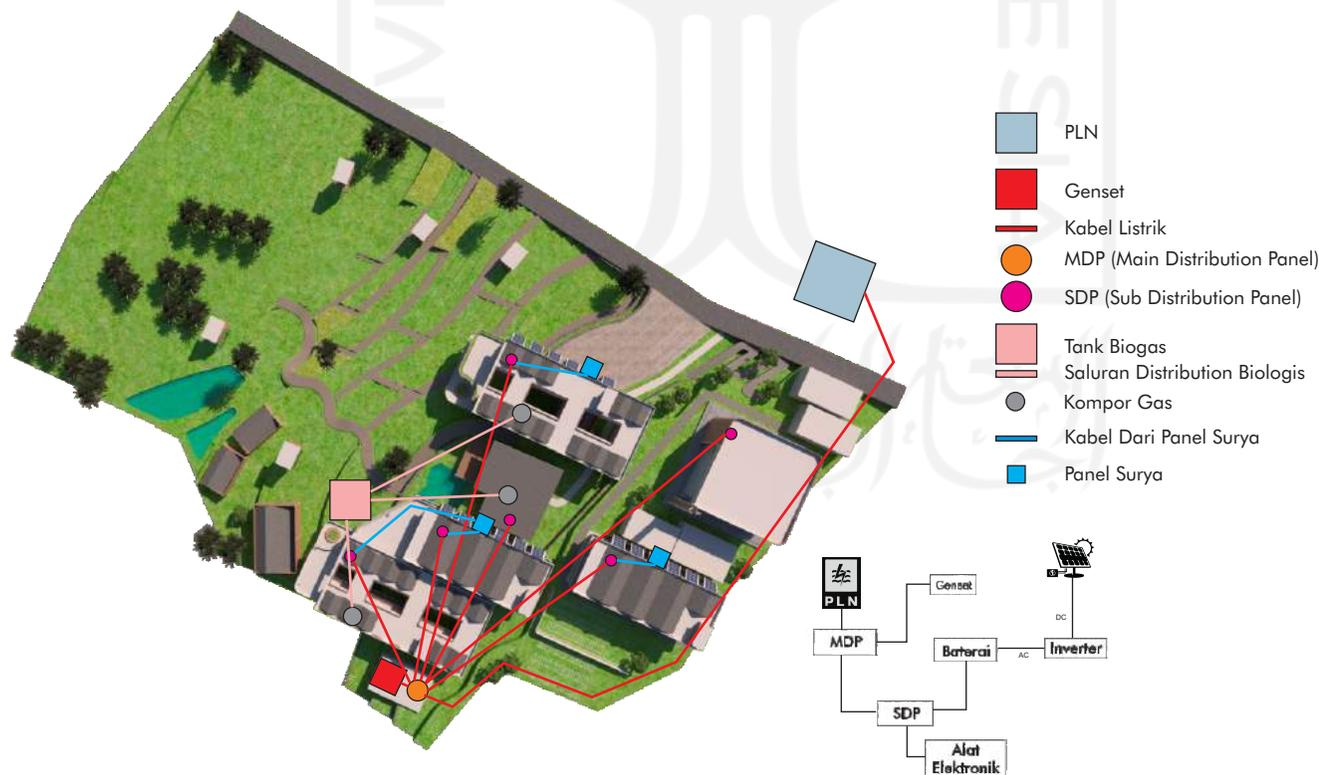
Gambar Skematik Penyediaan Energi
