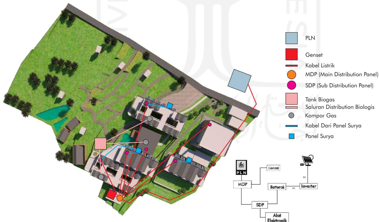
Gambar Skematik Penyediaan Energi
