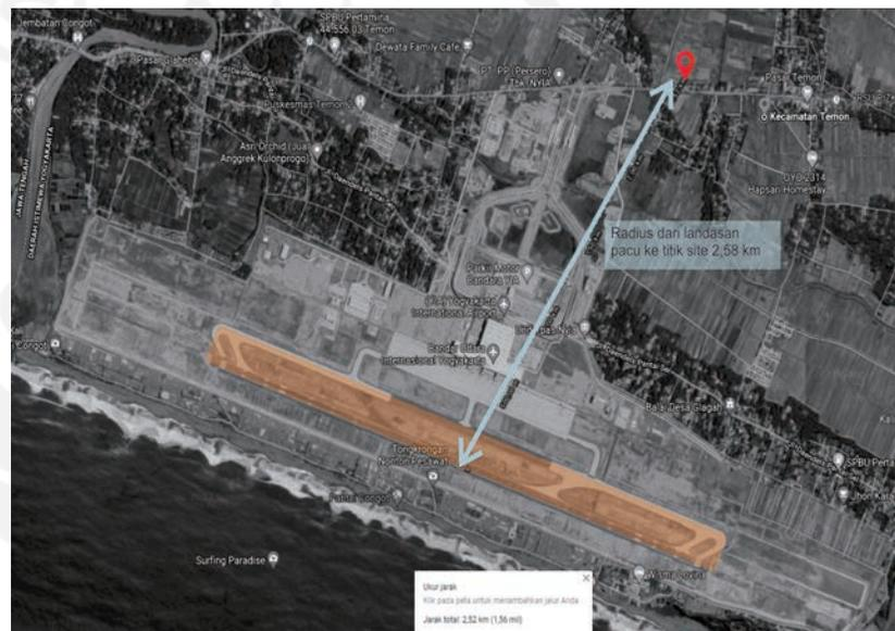
Berdasarkan SNI 03-7112-200 mengenai Kawasan Keselamatan Operasi Penerbangan. area site merupakan area permukaan horizontal dalam dikarenakan jaraknya yaitu 2,58 km dari landasan pacu, sehingga ketinggian bangunan yang diizinkan adalah 45m.
