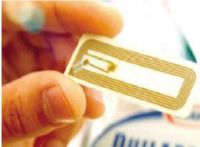
Gambar 2.2 RFID tag dengan silicon chip dan antena eksternal
