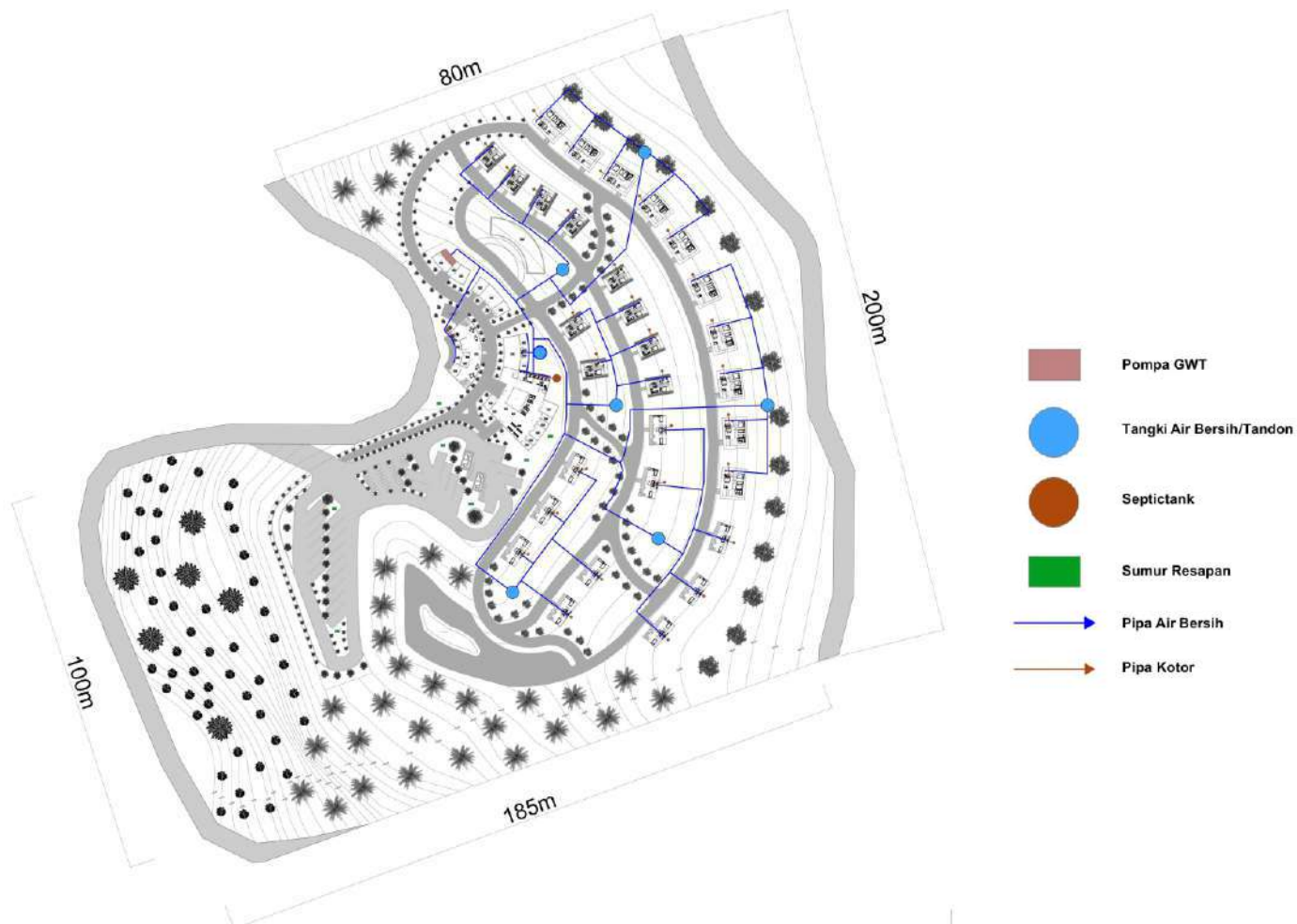
Gambar 6.47 Rancangan Skema Air Bersih dan Air Kotor
