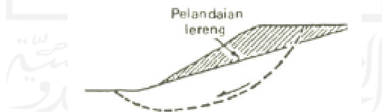
Gambar 3. 3 Tipe keruntuhan lereng gabungan (sumber: Santoso Budi,1998)
