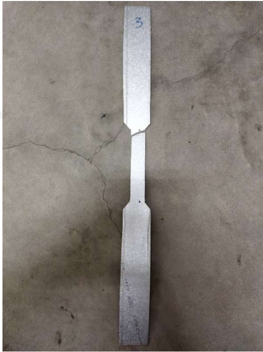
Gambar 5. 12 Kerusakan Pada Sampel Uji Pelat Baja Ringan Profil C75x0,75
