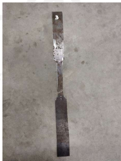
Gambar 5. 11 Kerusakan Pada Sampel Uji Pelat Baja Tebal 1,5 mm
