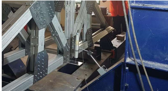
Gambar 4. 17 Pemasangan Alat LVDT dan Bidang Referensi Pada Sampel Uji
