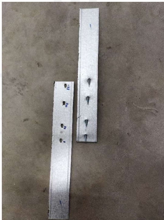
Gambar 5. 13 Kerusakan Pada Sampel Uji Sambungan Baut
