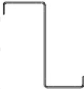
Gambar 3. 5 Penampang Baja Ringan Profil Z (SNI 8399-2017)
