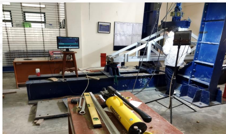
Gambar 4. 10 Loading Frame dan Hydraulic Jack
