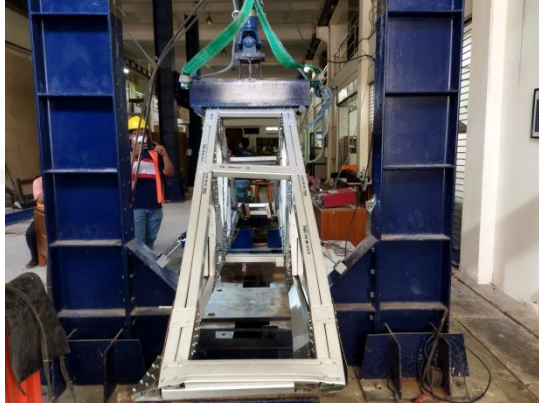
Gambar 5.16 Kegagalan Tumpu Pada Struktur rangka Double Channal Front to Front
