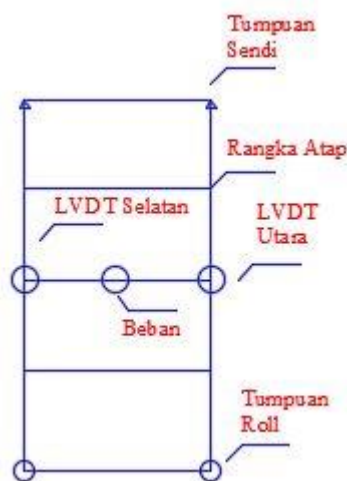
Gambar 5.14 Ilustrasi Penempatan Alat Saat Pelaksanaan Pengujian
