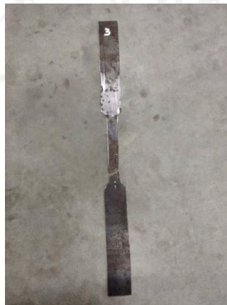
Gambar 5.11 Kerusakan pada sampel pelat baja setebal 1,5 mm
