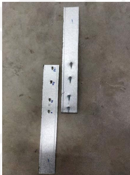
Gambar 5.13 Kerusakan Salah Satu Sampel Uji Sambungan Baut
