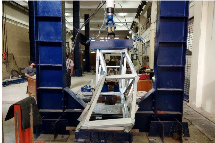
Gambar 5.15 Kegagalan Pada Struktur Rangka Profil Single Channel
