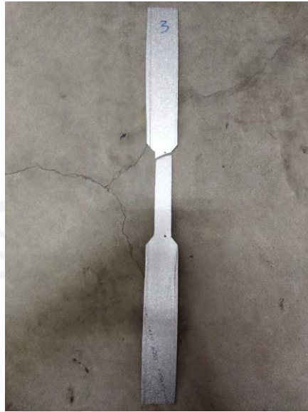
Gambar 5.12 Kerusakan Pada Sampel Baja Ringan Profil C75x0,75
