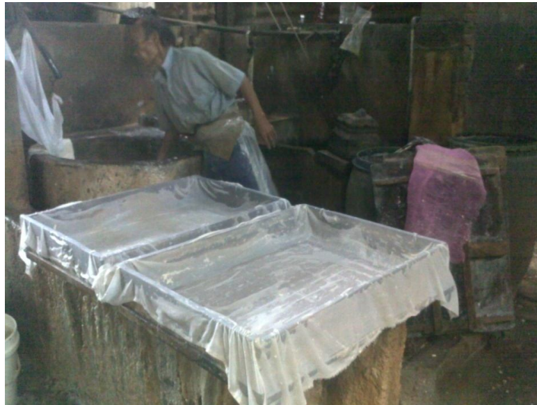
Gambar 4.43 Stasiun Pencetakan Setelah Dilakukan Perbaikan Pada Gambar 4.35 sampai gambar 4.42 menunjukkan antara stasiun kerja pencetakan tahu yang lama dengan stasiun pencetakan tahu yang baru. dan gambar 4.43 merupakan gambar hasil desain stasiun kerja pencetakan tahu.
