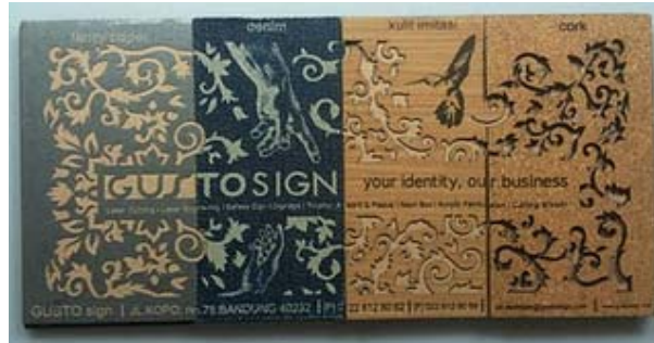
Gambar 2-5 Hasil pengerjaan dengan mesin laser cutting (laser cut & engraving fancy paper-jeans-leather-cork)
