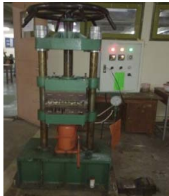
Gambar 3-3 Mesin kempa panas ( hot press )
