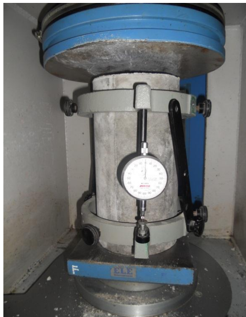
Gambar 4.19 Pelaksanaan Uji Kuat Desak
