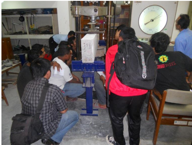
Gambar 4.20 Pelaksanaan Pengujian Lentur Balok Beton
