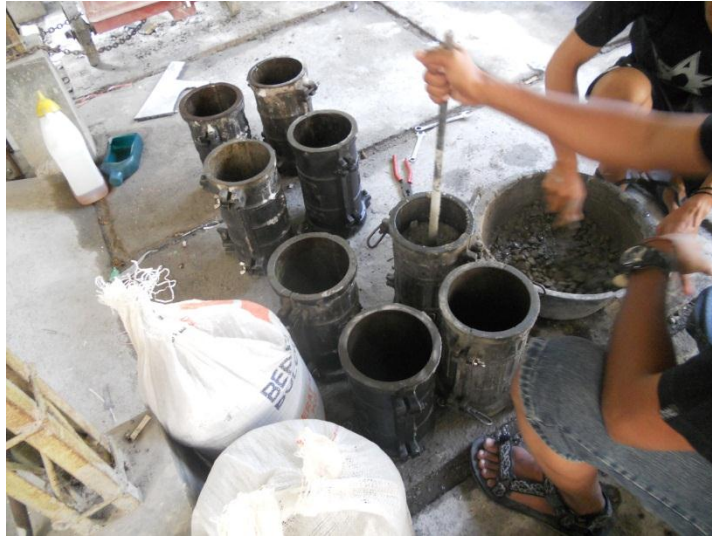
Gambar 4.16 Pembuatan Benda Uji Balok dan Silinder Beton
