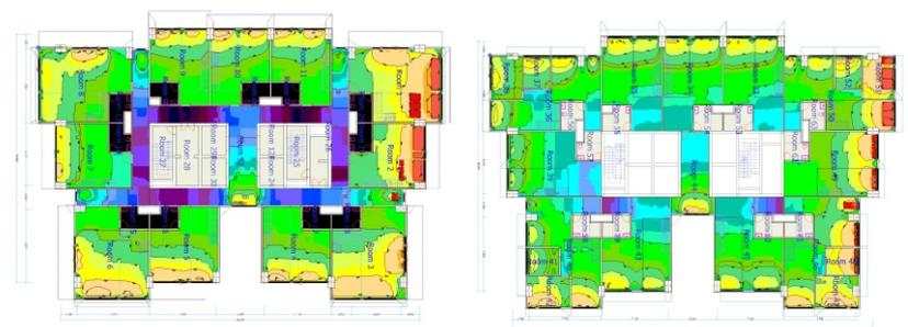
Gambar: Hasil uji daylighting Unit Tower B pada jam 09.00 tanggal 22 Desember.
