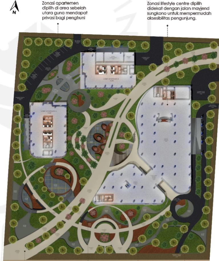
**Entrance pedestrian** diletakkan pada ujung-ujung site untuk menghubungkan pedestrian eksisting, lalu jalur pedestrian tersebut sengaja dibuat lengkung.
