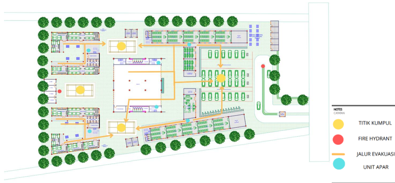
Gambar 5.5.8 Skema Keselamatan Kebakaran
