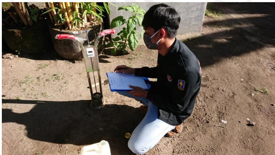
Gambar L-1.4 Proses Pengujian Infiltrasi Tanah (Mencatat Hasil Infiltrasi Tanah)
