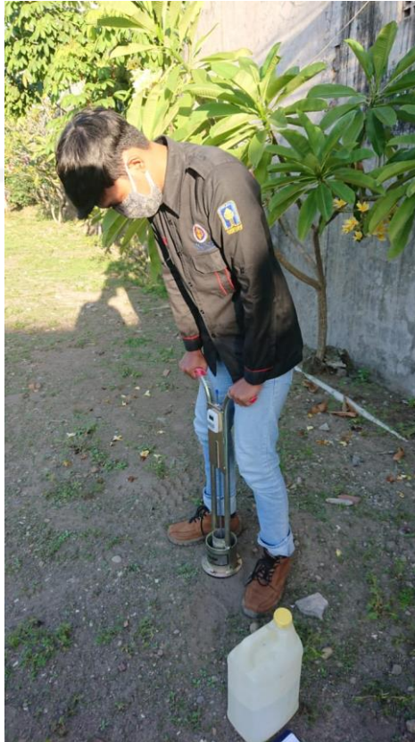
Gambar L-1.1 Proses Pengujian Infiltrasi Tanah (Pemasangan Alat Uji Ring Infiltrometer)
