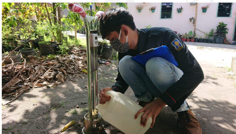
Gambar L-1.2 Proses Pengujian Infiltrasi Tanah (Menuangkan Air Ke Dalam Ring)
