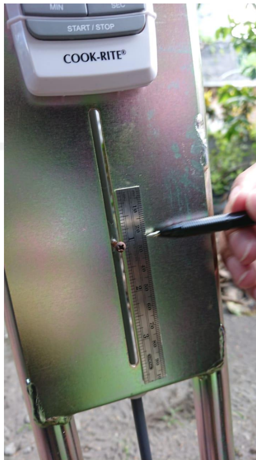
Gambar L-1.3 Proses Pengujian Infiltrasi Tanah (Mengamati Penurunan Infiltrasi Tanah)
