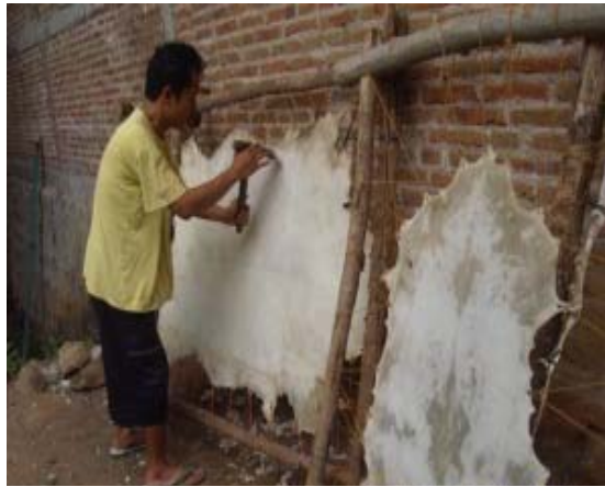
Gambar 2.1 Proses pengerokan dan penjemuran
