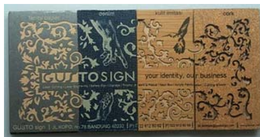
Gambar 2.8 Hasil pengerjaan dengan mesin Laser cutting (atas ke bawah: laser cut fancy paper, laser cut plywood, laser cut & engraving acrylic-hardcover-gravoply-MDF,
