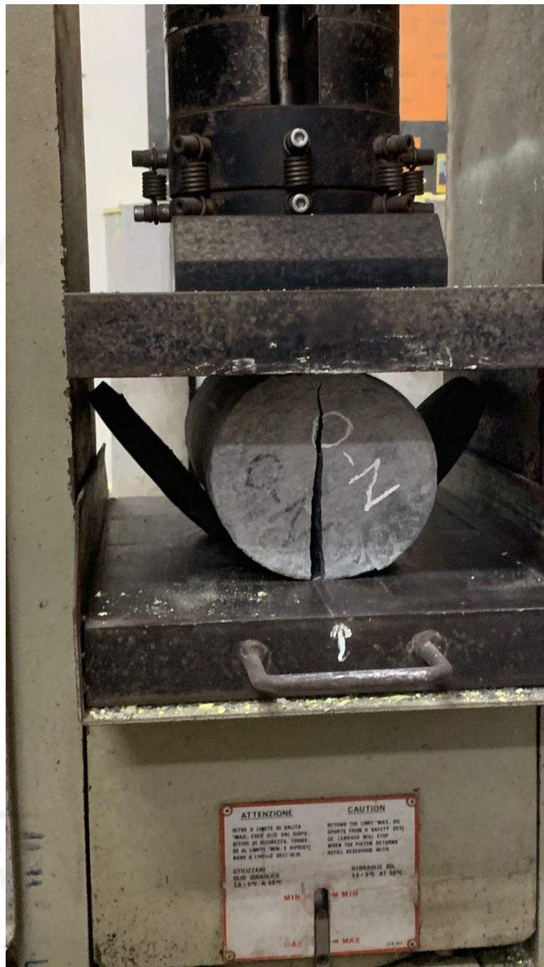
Gambar L.3.3 Proses Uji Tarik
