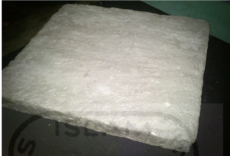
Gambar 3.12 Panel dinding ringan yang sudah jadi
