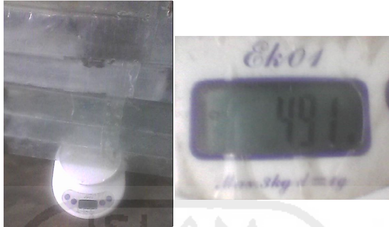
Gambar 3.9 Pengukuran berat panel dinding
