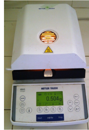
moisture balance (alat uji kadar air ekstrak, granul)
