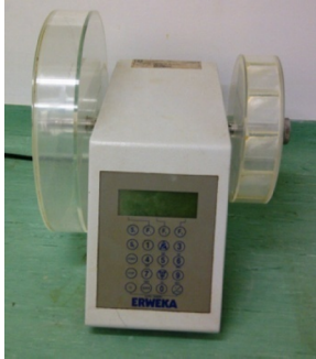
friabilator (alat uji kerapuhan tablet)
