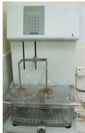
disintegrator tester (alat uji waktu hancur tablet)
