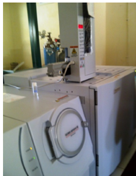
GC MS (alat uji sisa pelarut)
