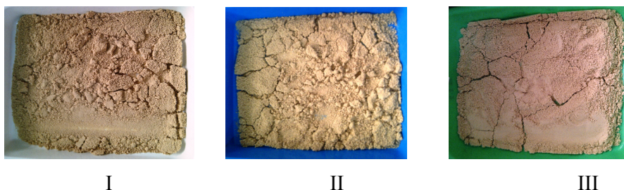
Gambar 7. Granul ekstrak buah mahkota dewa dengan variasi bahan pengikat formula I (amilum), II (PVP) III (gelatin). Formula I dan II menghasilkan granul dengan ukuran lebih besar dibandingkan granul formula III
