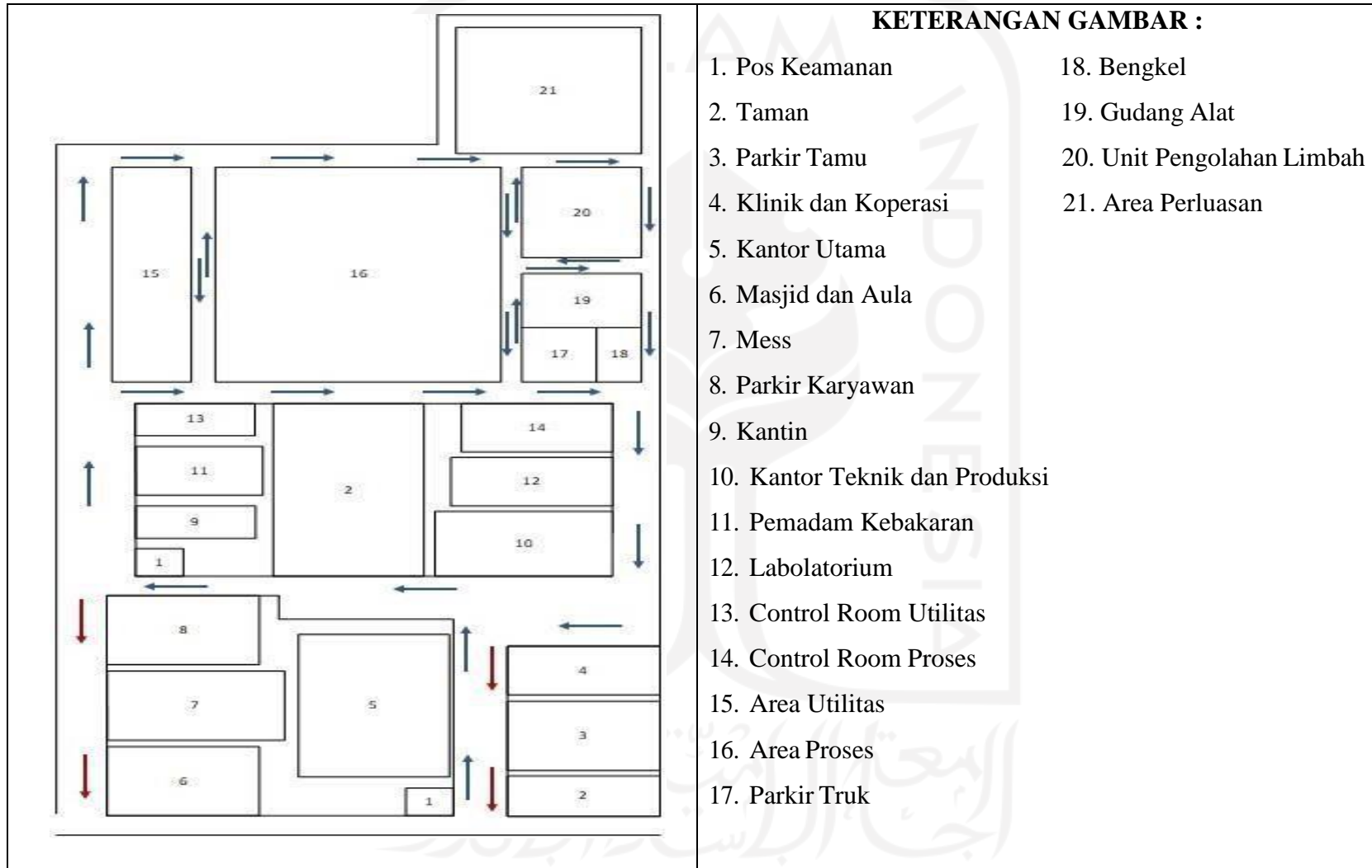
Gambar 4.2 Tata Letak Pabrik dengan Skala 1 : 1000
