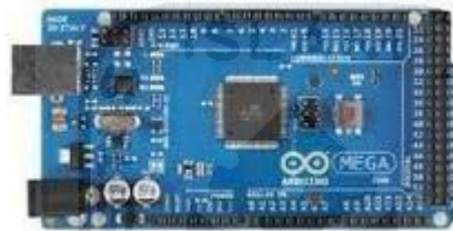
Gambar 2.2 Arduino Mega 2560 revisi 3
