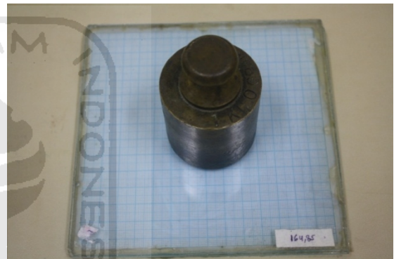
Uji Daya Sebar
